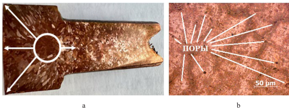
Рис. 9. Макроструктура с градиентами температур (а) и микроструктура с распределённой микропористостью (б) литого электрода
